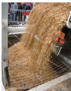
Scarico del cippato in silo interrato
