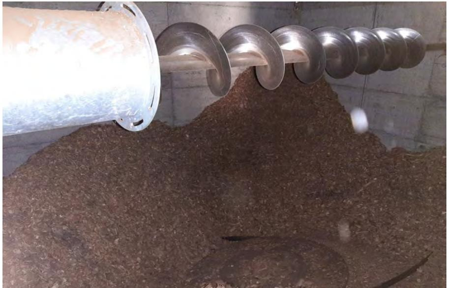
*Il deposito del cippato con particolare della coclea per il riempimento*
