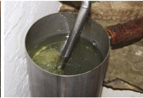
*L'alambicco, il condensatore e la miscela acqua-olio prima della decantazione naturale*
