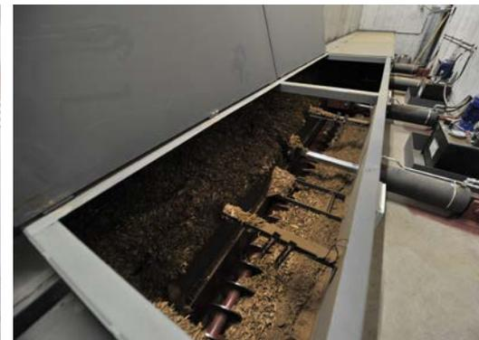
A sinistra e al centro: il deposito di stoccaggio del cippato. A destra: il sistema di prelievo del cippato dal deposito.
