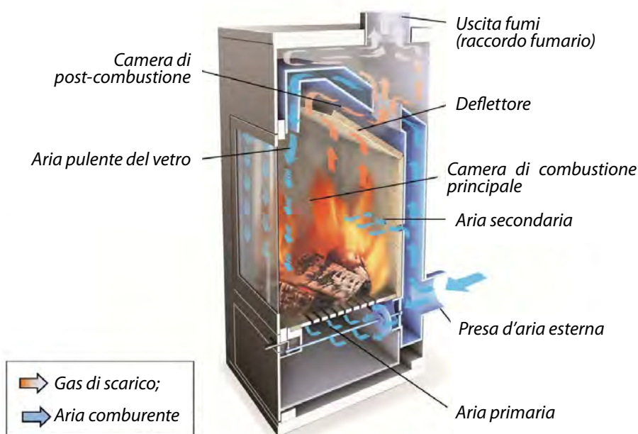
Figura 1. Struttura di una moderna stufa a legna (Fonte: TFZ).
