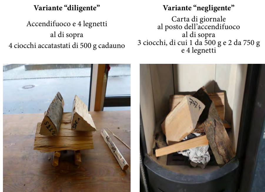
Figura 3. Accensione “diligente” (a sinistra) e “negligente” (a destra) a confronto.
