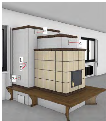
Posizione sonde di rilievo
