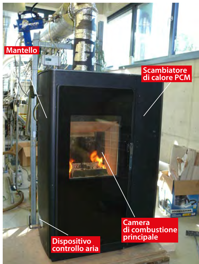
Figura 2 – La nuova stufa a legna con accumulatore PCM integrato (l'apparecchio è protetto da brevetto)
