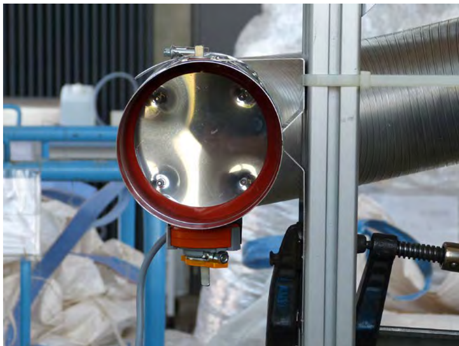
Figura 4 – Dispositivo di regolazione dell'aria a chiusura completa del canale da fumo.
