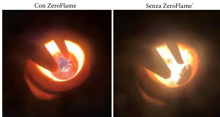
Figura 1 - Con la tecnologia “ZeroFlame” la fiamma scompare quasi completamente e si riducono al minimo le emissioni di particolato
