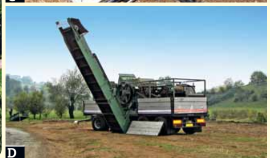
Foto A - Vista dell'azienda Dalle Rive a Zugliano (Vicenza). Foto B - La centrale termica. Foto C - Particolare del sistema di estrazione del cippato dal silo (rastrelli). Foto D - La cippatrice con motore autonomo impiegata per cippare i residui di lavorazione del vivaio
